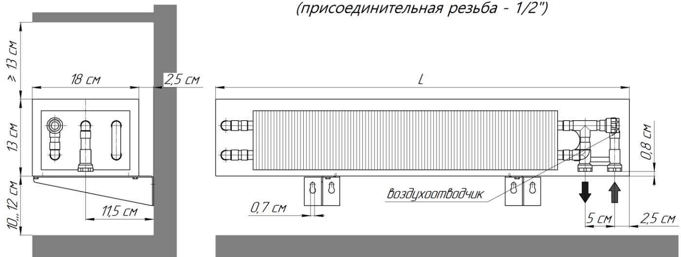
Настенный конвектор "Эlegant - мини 180x130-3то Терм Стен прав" с правосторонним нижним подключением (левостороннее - зеркально) с встроенным термоклапаном (присоединительная резьба - 1/2")
