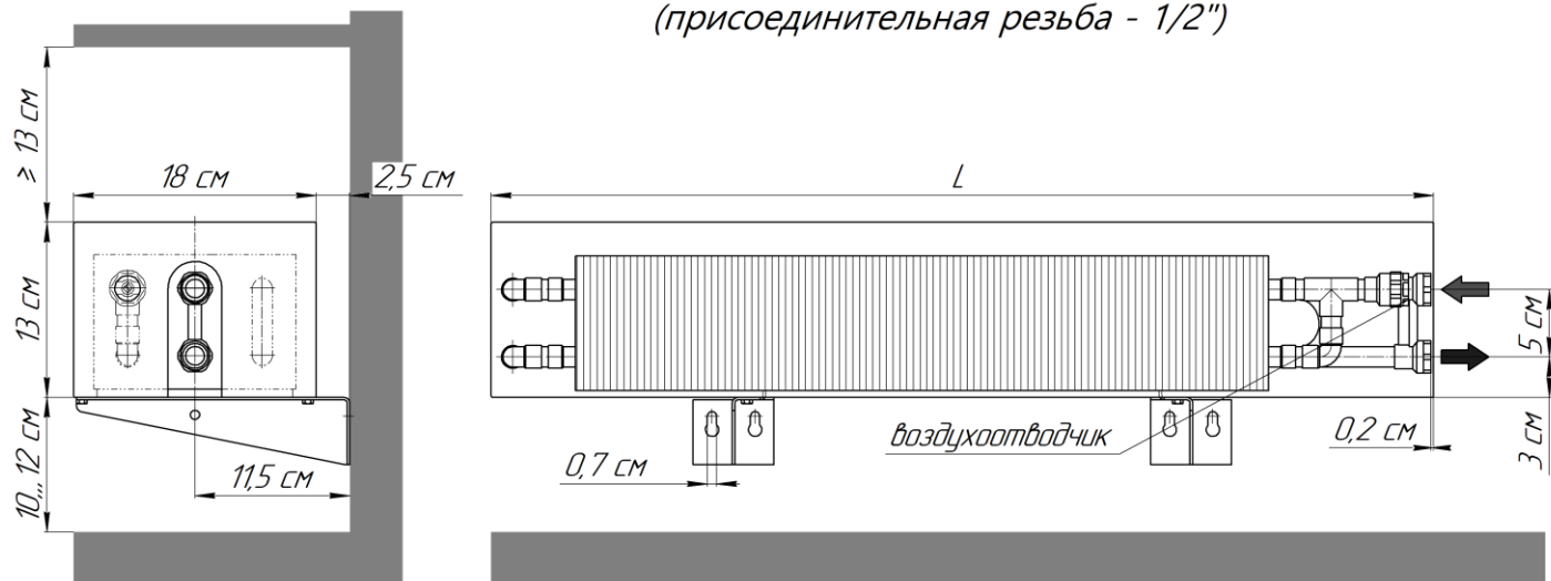
Настенный конвектор "Эlegant - мини 180x130-3то Стен прав" с правосторонним нижним подключением (левостороннее - зеркально) (присоединительная резьба - 1/2")
